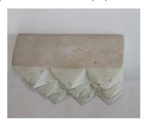
Рис. 1. Фигурный элемент мощения с рифленой основой из девяти зубчатых элементов пирамидальной фор мы
